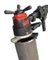
PRO-10 PB Vnútorne úkosovanie do 84mm Pipe ID up to 84 mm Vonkajšie úkosovanie do 273mm OD up to 273mm
