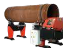
PRO-40 PBS Vonkajšie úkosovanie 200-1000mm Pipe OD 200-1000mm
